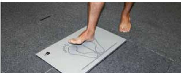
Figura 8. Detalle de la plataforma dinamométrica utilizada para la valoración de la marcha.
