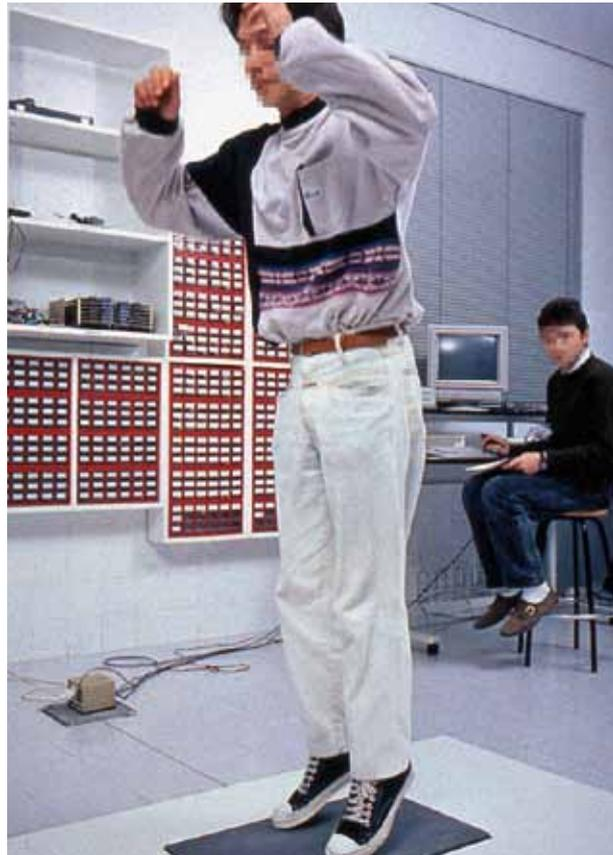
Figura 2. Investigación sobre gesto de salto utilizando plataformas dinámicas (IBV, principios de los 90).
