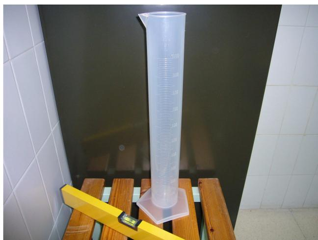
**Figura 11. Superficie nivelada donde se apoya la probeta.**
