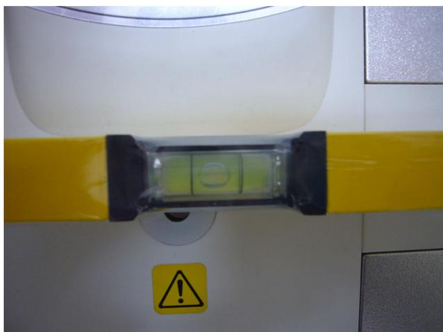
**Figura 8. Nivelación de la balanza utilizada en la investigación.**
