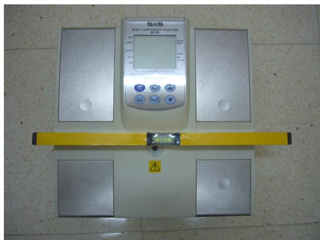
**Figura 7. Nivelación de la balanza utilizada en la investigación.**
